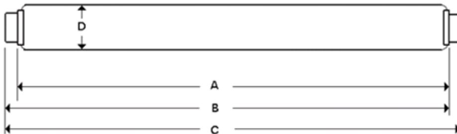
**Figura B3: Dimensiones de la lámpara con casquillo R17d**
